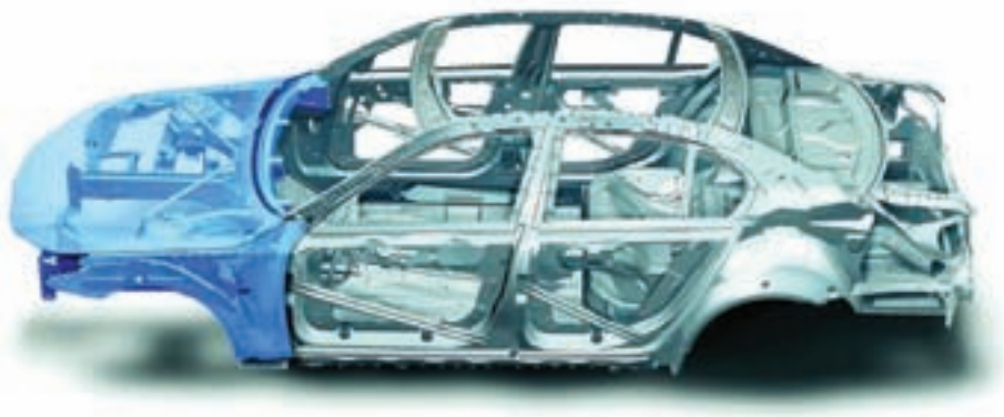
1 Rohkarosserie der BMW 5er-Reihe mit Vorderbau, Motorhaube und Kotflügel aus Aluminium (Bild: Alcan Automotive)
