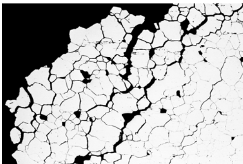
Interkristalline Korrosion austenitischen CrNi-Stahls
