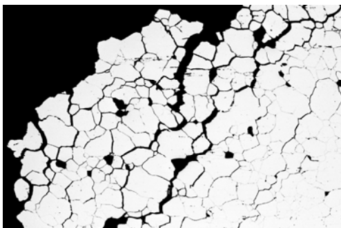
Interkristalline Korrosion austenitischen CrNi-Stahls
