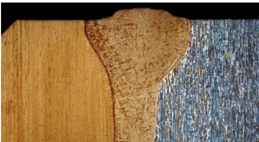
EB-Schweissung zweier unterschiedlicher Stähle
