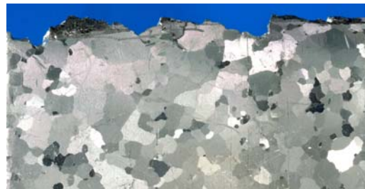
Makroschliff eines gerissenen Alubleches
